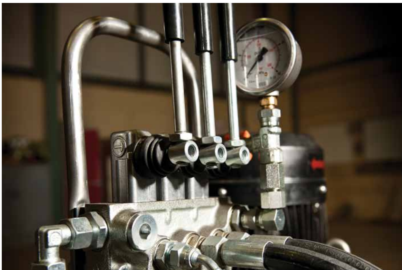
Гидравлический узел регулировки отражающей плиты и открытия дробилки
